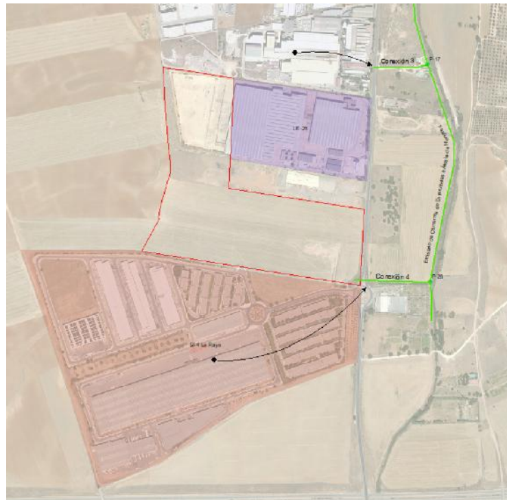
Esquema de conexión de las aguas negras al emisario de Camarma
