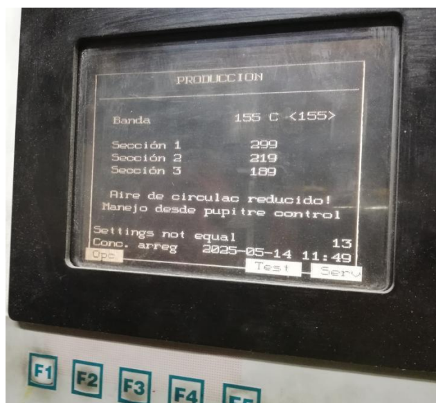
Imagen 9: Ejemplo de pantallas del display de control de la rotativa Lithoman V.
