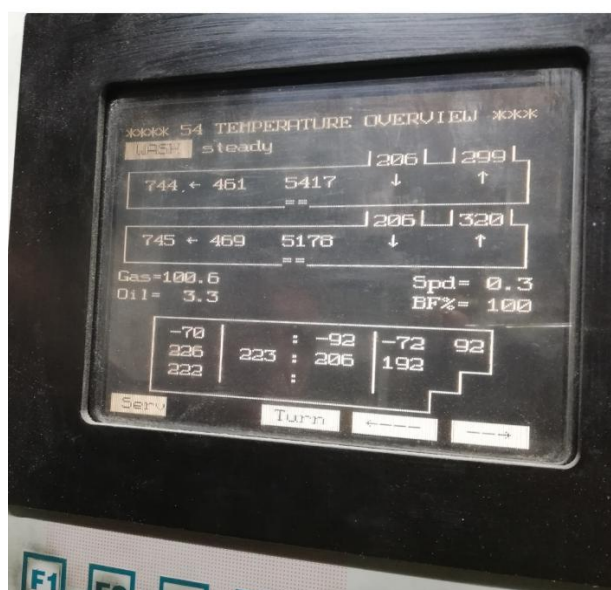
Imagen 10: Ejemplo de pantallas del display de control de la rotativa Lithoman V.
