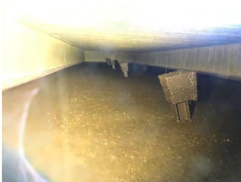
Interior del reactor anaerobio. Eje de mezcla horizontal en todo el largo.
