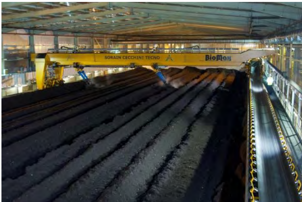
Sistema automatizado de compostaje del digesto producido
