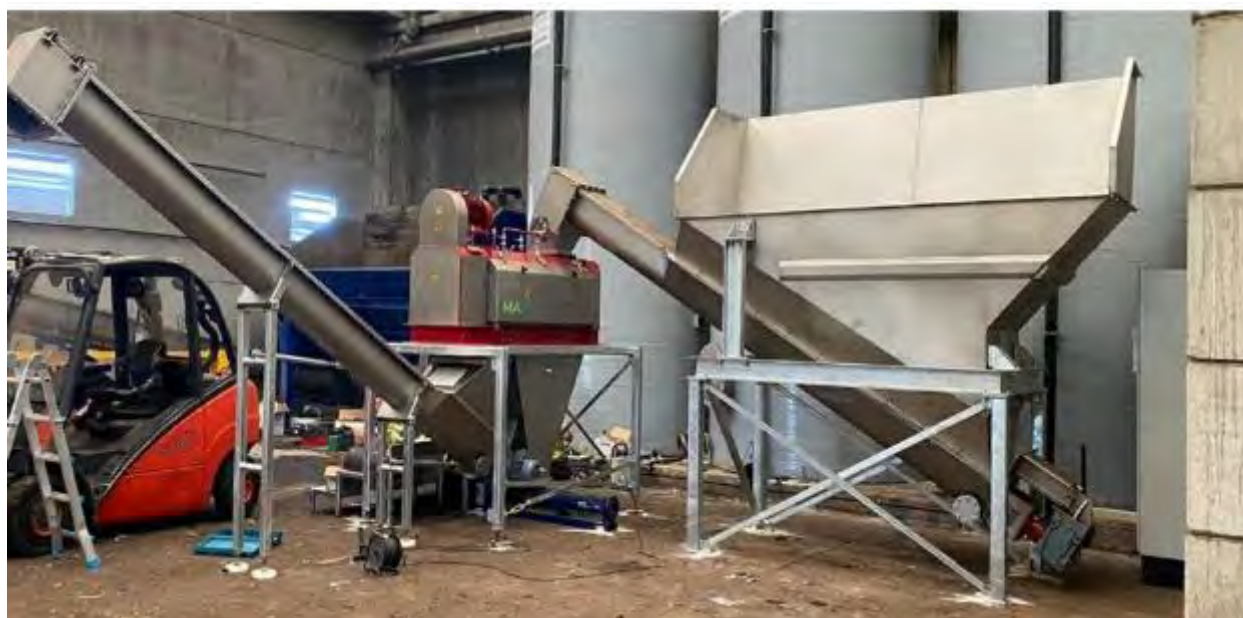
Equipo de trituración y separación de envases de residuos comerciales biodegradables
