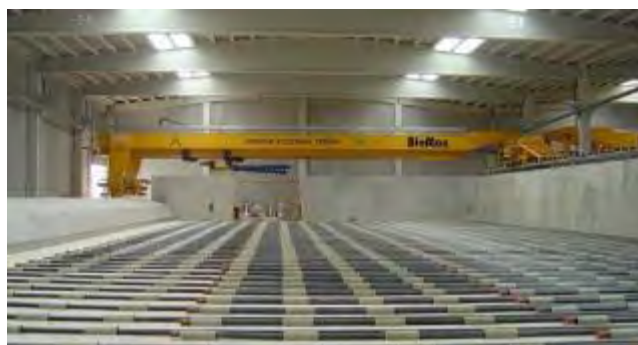
Ventiladores y fondo del sistema de aspiración forzada
