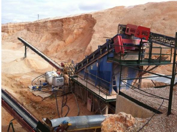
Imagen 10. Detalle de la planta experimental de recuperación de estériles.
