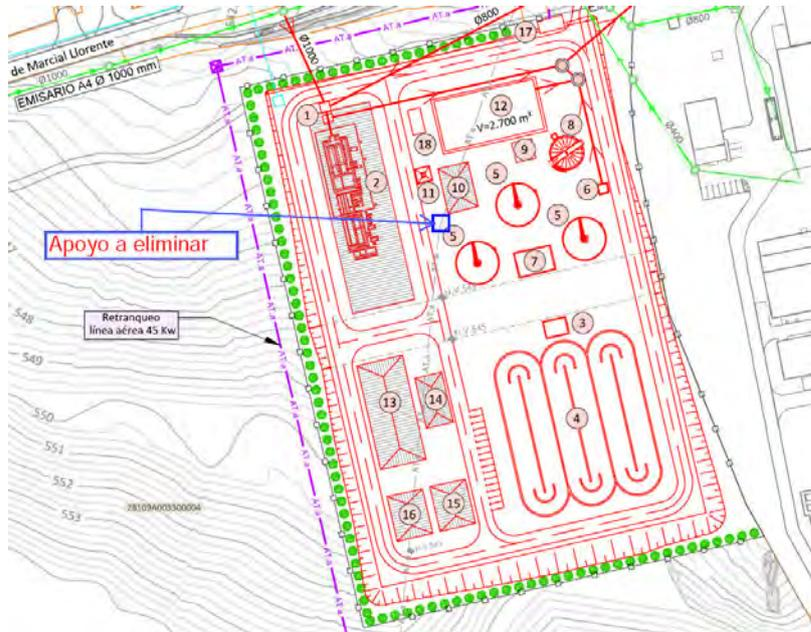
Figura 2.3.4.9.- LAAT 45 kV existente, apoyo a eliminar y retranqueo de línea fuera EDAR.
