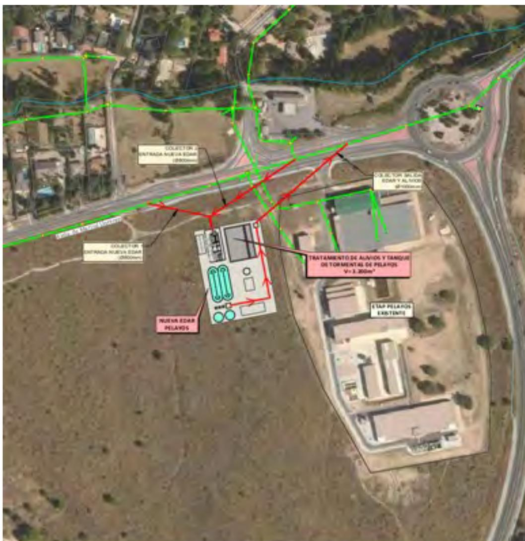
Figura 3.1.6.- Esquema de la Alternativa 2 EDAR Pelayos de la Presa. (Fuente: Canal de Isabel II)
