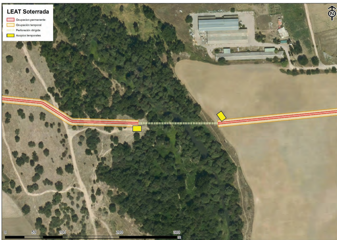
Figura 59. Cruce de la LEAT a su paso por el río Jarama. Fuente: elaboración propia.
