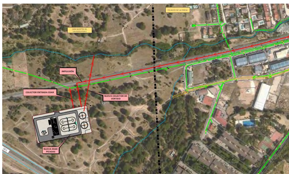
Figura 4.1.7.- Esquema de la Alternativa 3. EDAR San Martín de Valdeiglesias. (Fuente: CYII)
