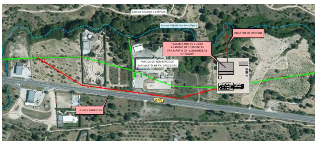
Figura 4.1.9.- Esquema de la Alternativa 3. Tanque Tormentas San Martín de Valdeiglesias. (Fuente: CYII)
