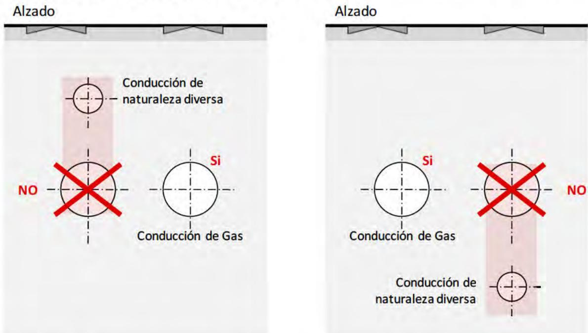
En recorridos paralelos, queda expresamente prohibida la instalación de la tubería de gas en la proyección vertical, tanto por encima como por debajo, del servicio encontrado (ver dibujo). Adicionalmente se procurará el mayor distanciamiento posible a juntas en canalizaciones de otros servicios y a tubulares no estancas.
