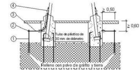
Puesta a tierra en apoyos con cimentación mixta y en roca no frecuentada
