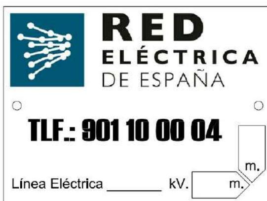
Adicionalmente, en una de las caras del hito se colocará una placa de identificación con el teléfono de emergencia y el logotipo de Red Eléctrica.
