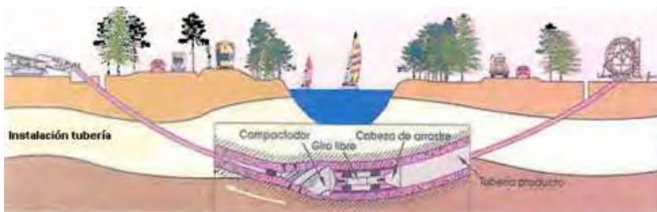
Imagen 5. Instalación de la tubería.
