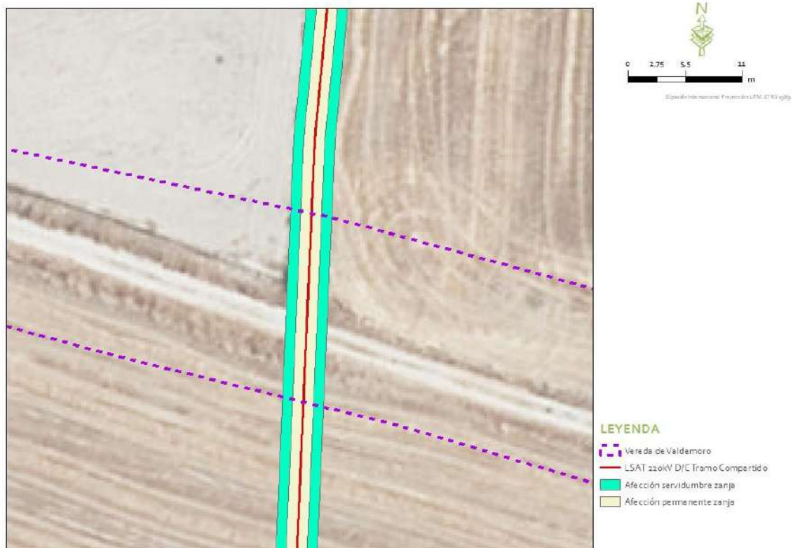
Figura 4.1.2.a Afecciones por cruzamientos en la Vía Pecuaria “Vereda de Valdemoro”
