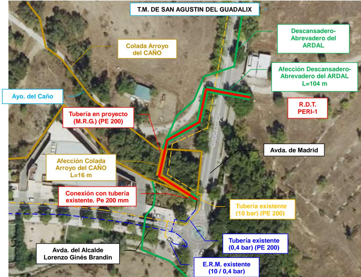
**FOTO Nº 2:** CONEXIÓN CON TUBERÍA EXISTENTE. ZONA DE AFECCIÓN A LA COLADA DEL ARROYO DEL CAÑO.
