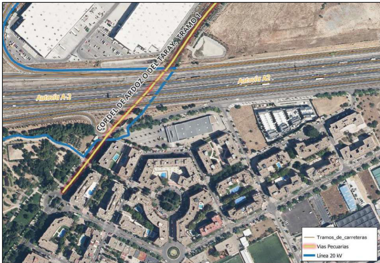
Figura 5. Vista en detalle del trazado de la línea 20 kV coincidente con la vía pecuaria “Cordel de Ardoz del Taray, Tramo 1” y el cruce con la Autovía A2. Fuente: Elaboración propia a partir del Proyecto de “Instalación de nueva acometida y centro de seccionamiento para el Centro de Control de tráfico aéreo de Torrejón” de ENAIRe e IGN.
