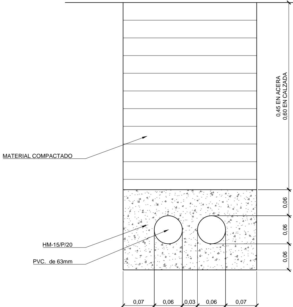
DETALLE CANALIZACIÓN 2C.PVC 63mm B2
