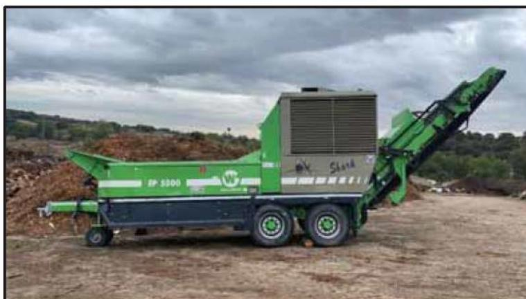
Figura 18: Trituradora-astilladora. Fuente: Elaboración propia.
