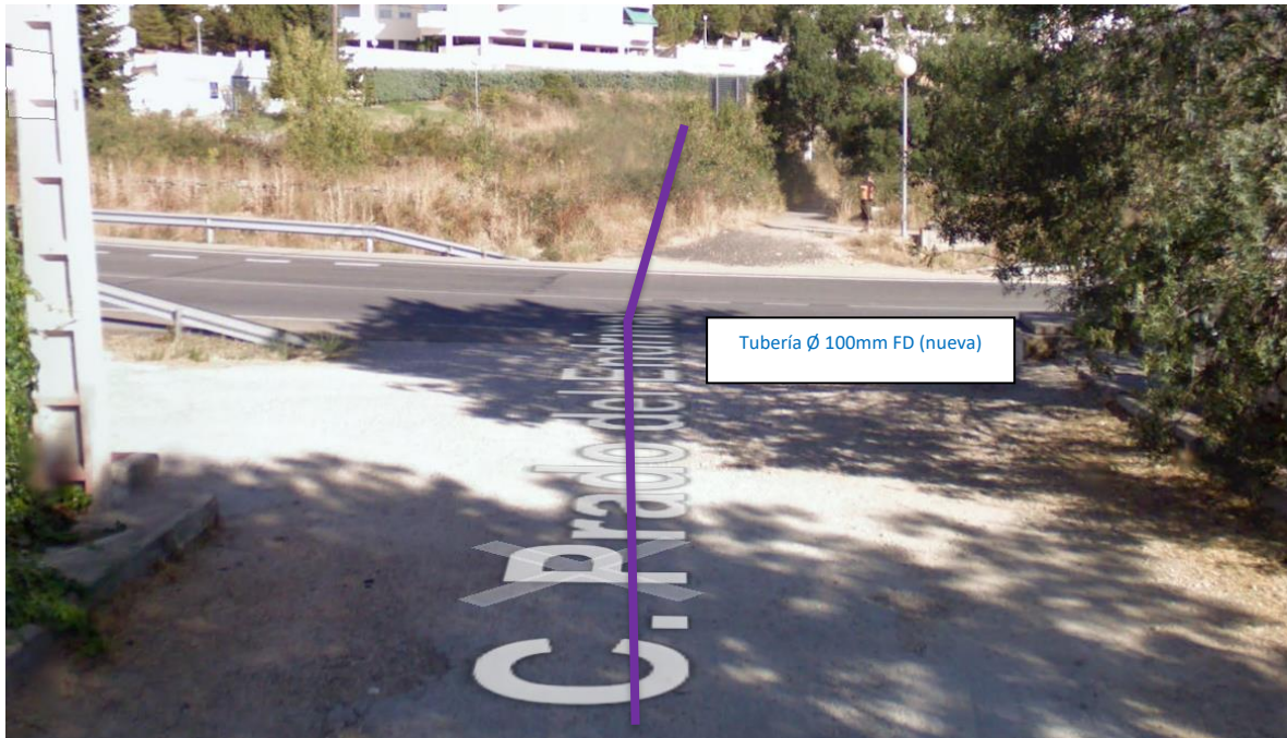
Fotografía 1. Inicio de tramo a renovar desde la Calle Prado del Endrinal. Tramo de cruce de la M-608.
