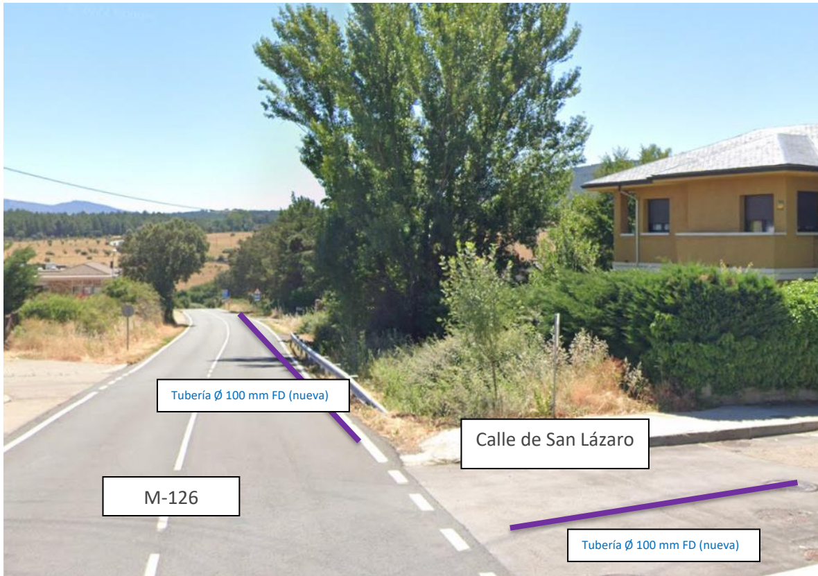
Fotografía 5. Afección en la carretera M-126 y en el descenso de la calle San Lázaro.
