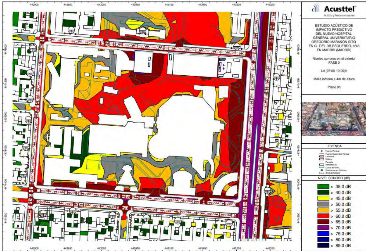
Figura 53. Mapa de Ruido total en el entorno del ámbito en el periodo de día, FASE 0. Fuente: Estudio acústico de impacto predictivo del nuevo Hospital General Universitario Gregorio Marañón en Madrid elaboración propia
