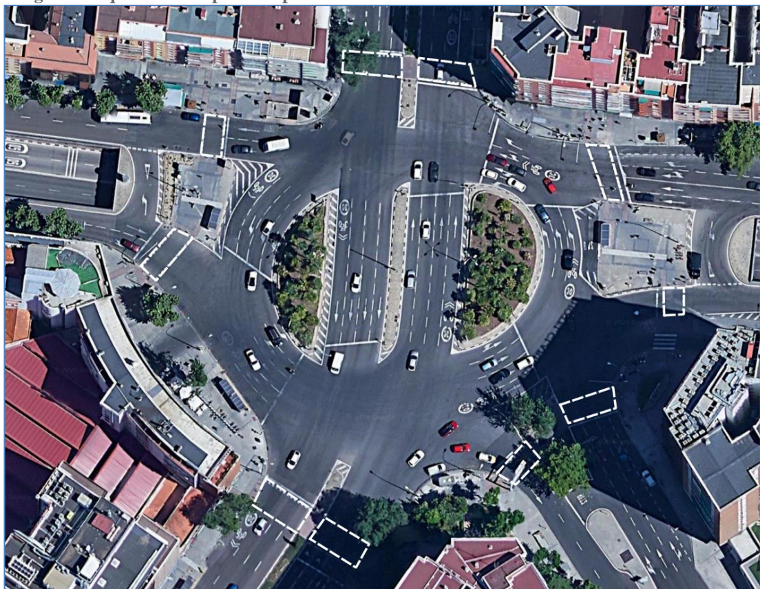
Imagen 6: Esquema de los pasos de peatones en la Plaza de Conde de Casal
