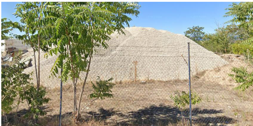
Figura 47. Acopio de grava para la fabricación de hormigón.
