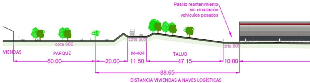
Figura 10. Sección esquemática de integración con casco urbano Torrejón de Velasco
