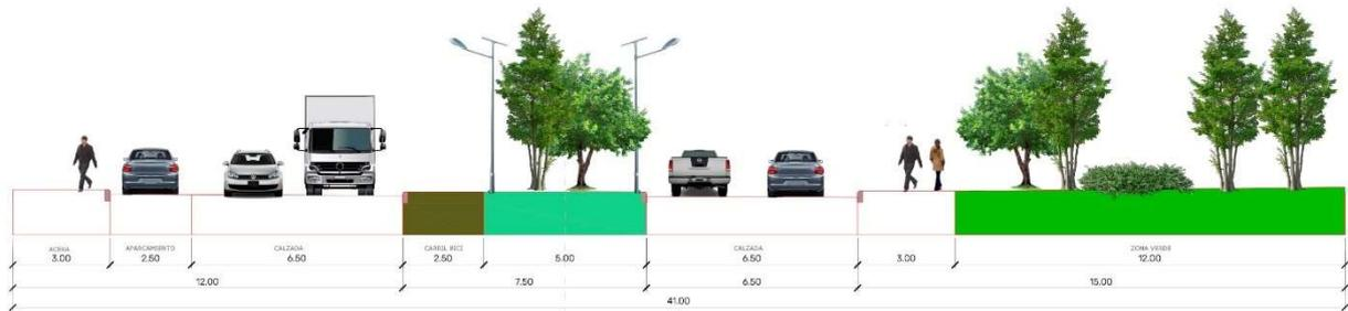
Figura 18. Sección de Viario tipo 3
