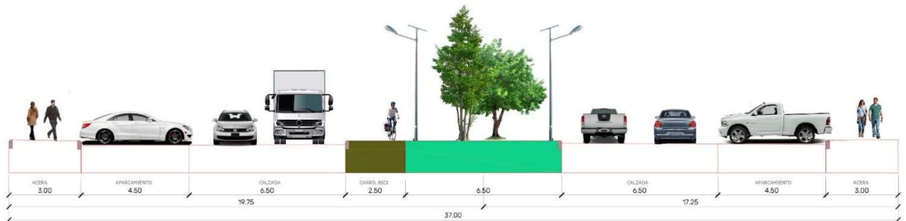
Figura 16. Sección de Viario tipo 1 (Bulevar central)
