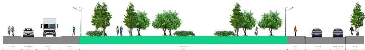
Figura 19. Sección de Viario tipo 4
