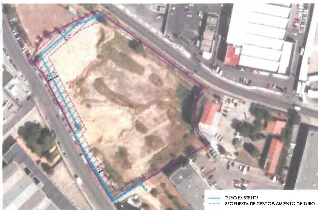
Figura 9: Propuesta de desdoblamiento de tubo existente.
