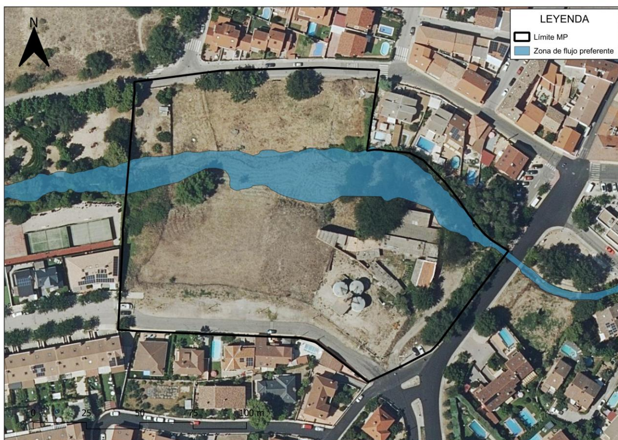
Zona de flujo preferente en los terrenos de la Modificación. Fuente: Ministerio de Transición Ecológica y Reto Demográfico.
