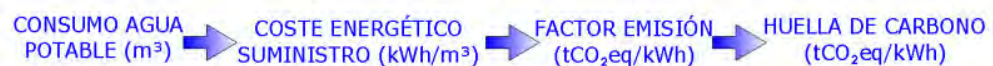
Figura 6.4.2.1. Esquema metodológico para el cálculo de la huella de carbono derivada del consumo de agua potable
