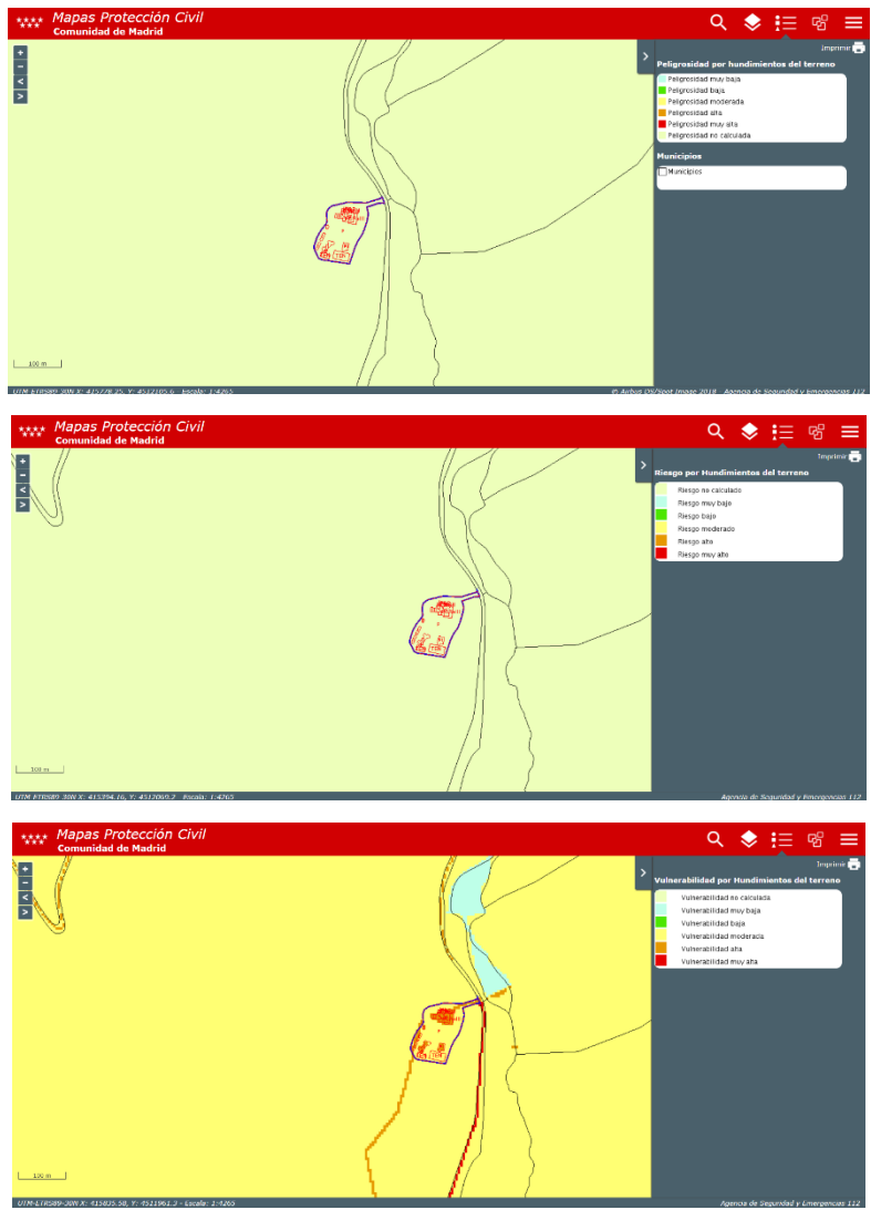
Figura 9. Peligrosidad, riesgos y vulnerabilidad por riesgo por hundimientos del terreno en la parcela con referencia catastral 000700100VL11B0000ZU. El polígono azul hace referencia a la parcela correspondiente al sitio del proyecto del hotel. Fuente: visor cartográfico de protección civil.
