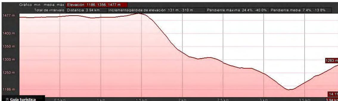
Figura 3.3.1.7- Perfil longitudinal Alternativa 4.
