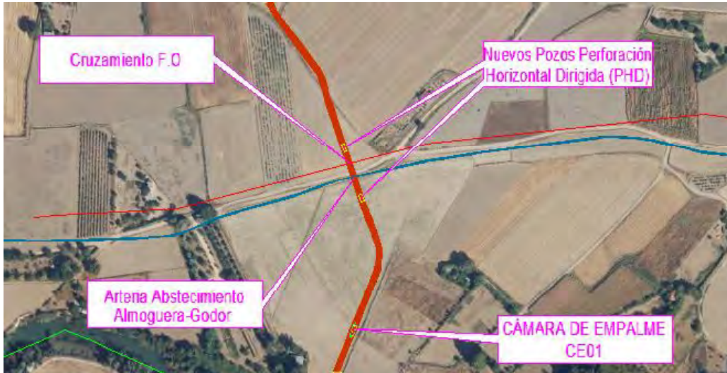
Imagen 1. Nueva Perforación Horizontal Dirigida para Arteria de Abastecimiento y línea FO existente.
