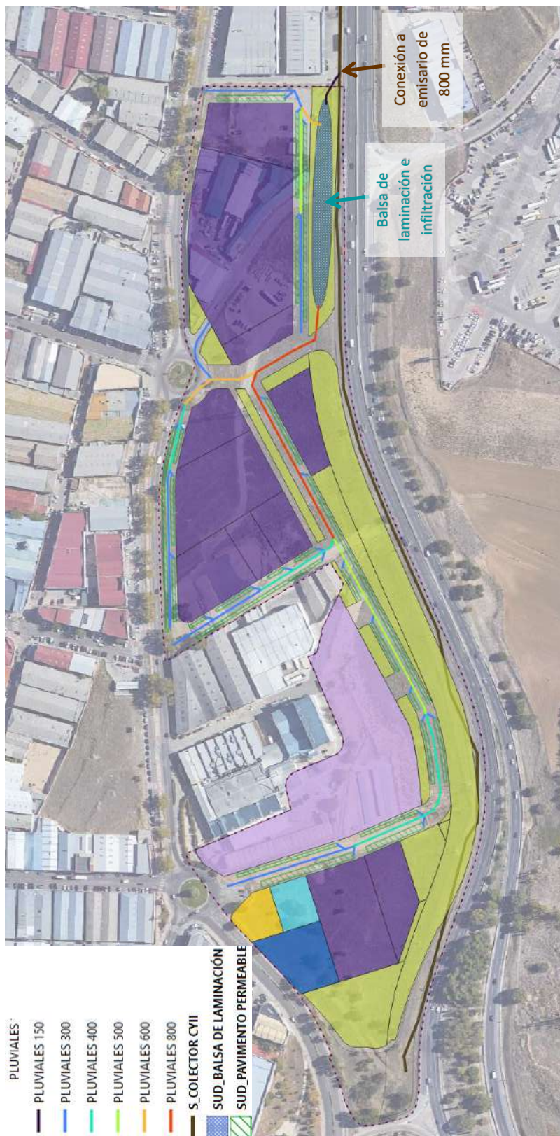
Red de aguas pluviales proyectada, con diámetros de 300 a 800 mm, con indicación de la balsa de laminación e infiltración del Plan Parcial de la Olivilla y salida de 150 mm hacia el colector existente de 800 mm
