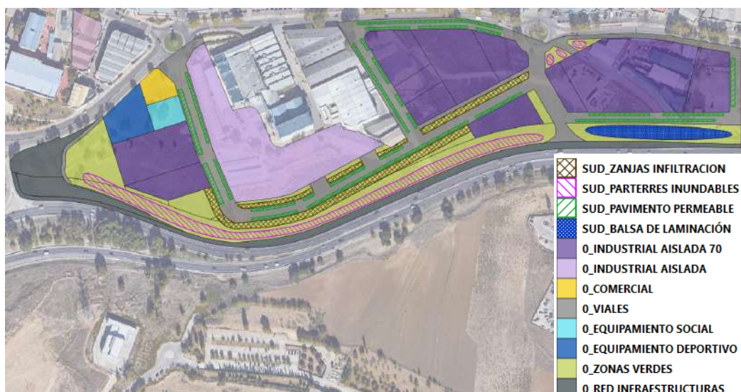
Usos de suelo futuros del Plan Parcial ámbito La Olivilla y sistemas de drenaje sostenible previstos
