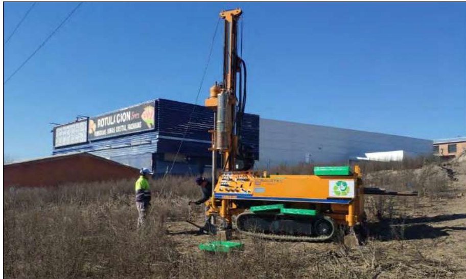
Fotografía 6. SONDA empleada RL 48 L DE ROLATEC. Fuente: elaboración propia.
