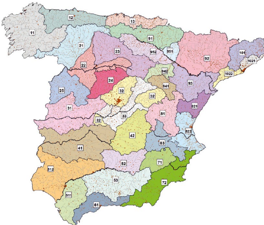
Figura 6. Caracterización del coeficiente corrector del umbral de escorrentía. Fuente: Norma 5.2-IC
