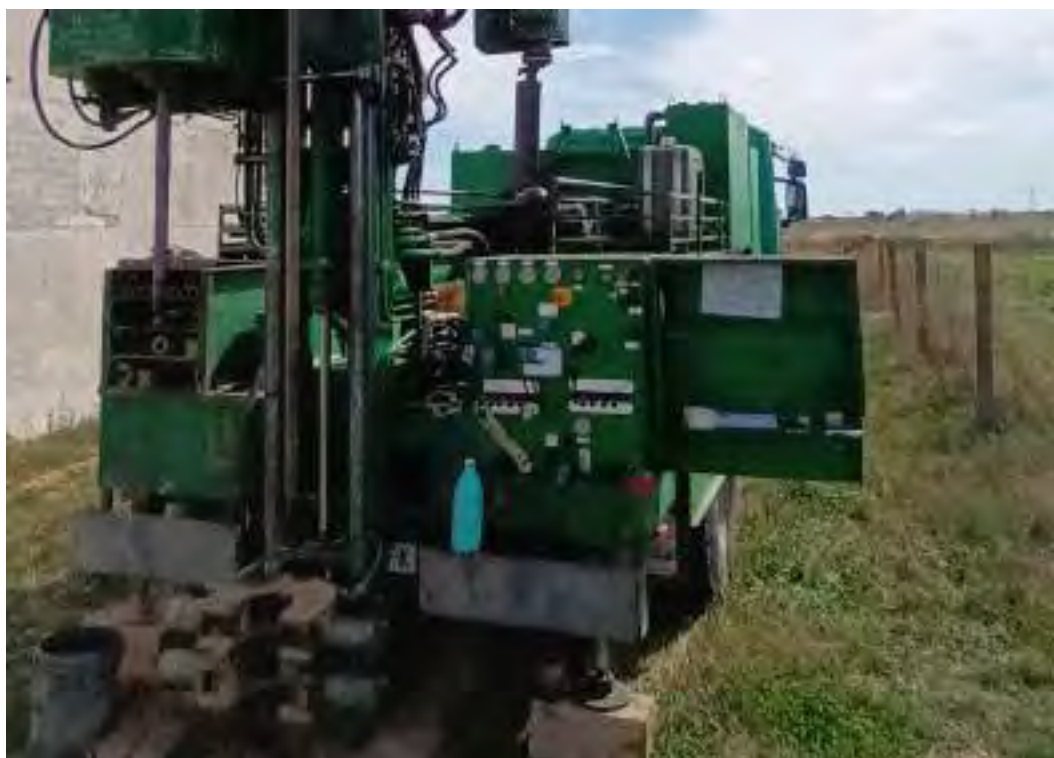
Figura Nº 11.- Imagen de la ejecución del sondeo mecánico y rotativo con extracción continua de testigo referido como S-04.
