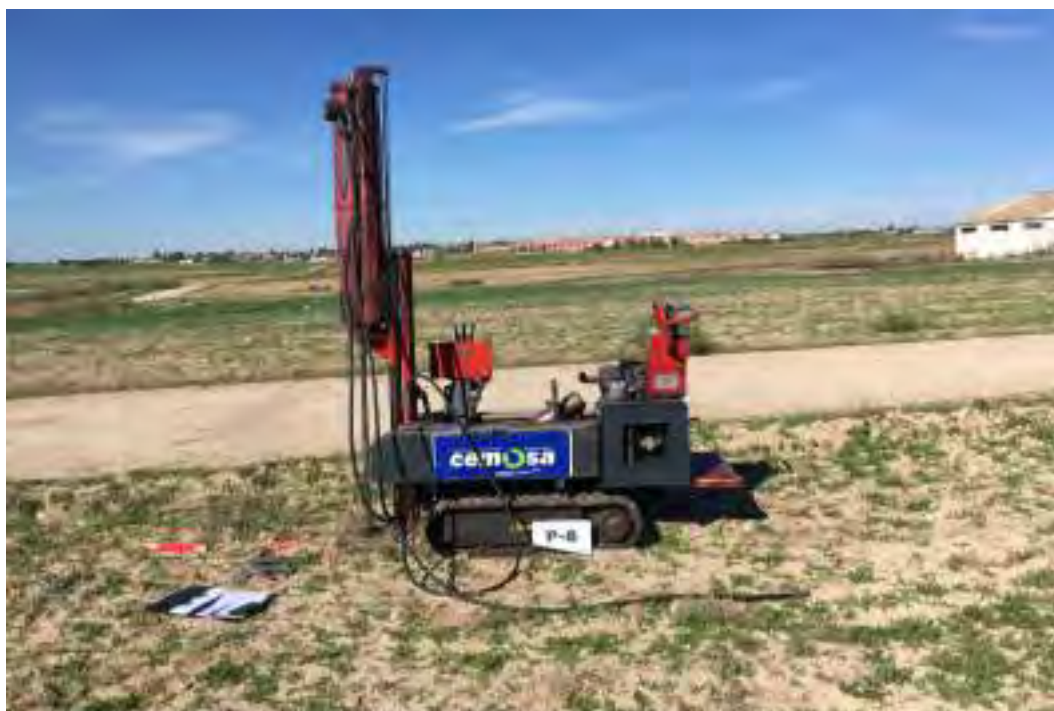
Figura Nº 29.- Trabajos para la realización de la penetración dinámica, tipo DPSH, referida como P-06.
