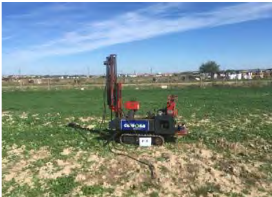
Figura Nº 25.- Trabajos para la realización de la penetración dinámica, tipo DPSH, referida como P-02.
