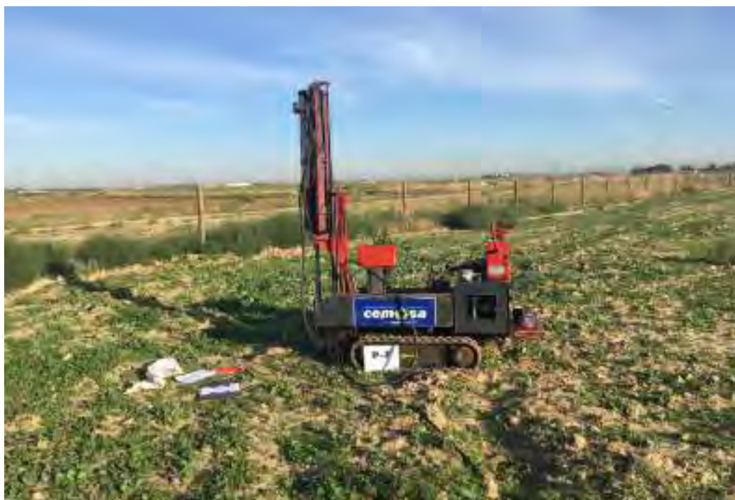
Figura Nº 30.- Trabajos para la realización de la penetración dinámica, tipo DPSH, referida como P-07.
