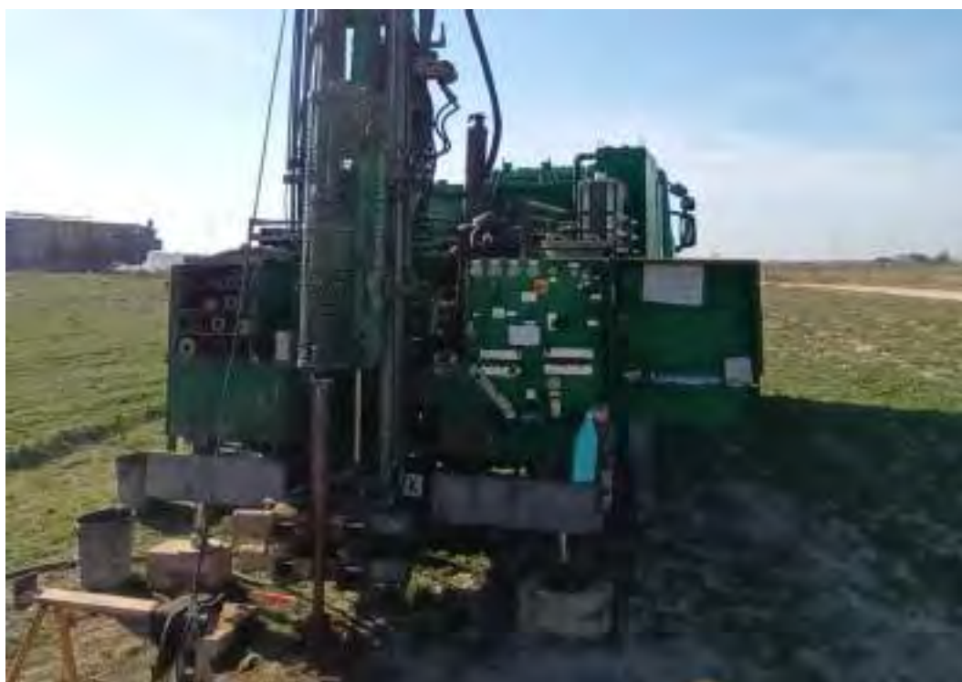
Figura Nº 12.- Imagen de la ejecución del sondeo mecánico y rotativo con extracción continua de testigo referido como S-05.
