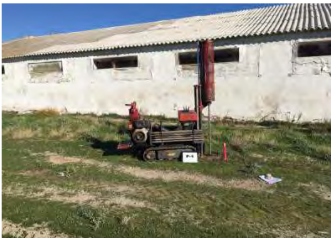
Figura Nº 28.- Trabajos para la realización de la penetración dinámica, tipo DPSH, referida como P-05.
