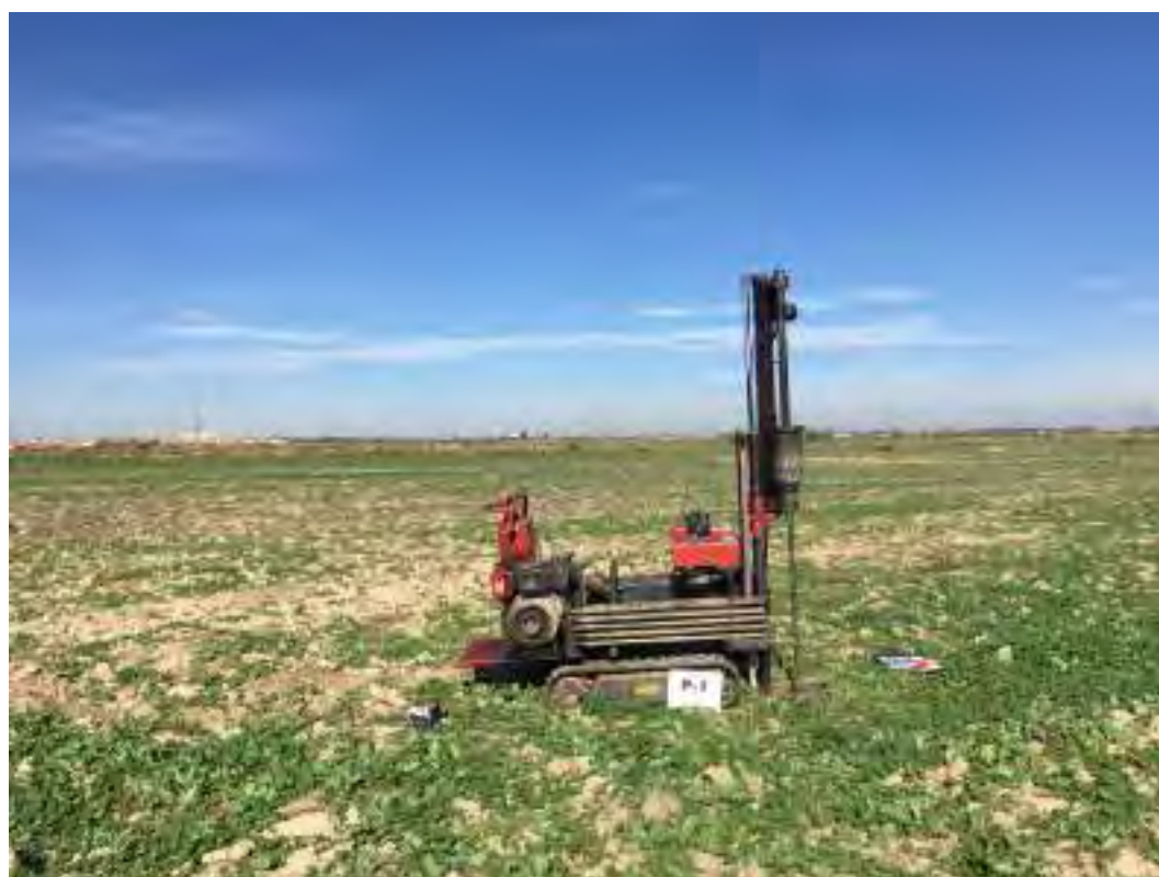
Figura Nº 24.- Trabajos para la realización de la penetración dinámica, tipo DPSH, referida como P-01.
