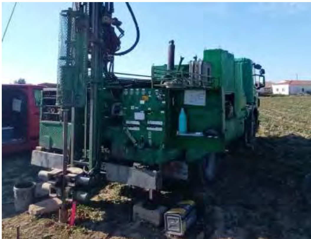
Figura Nº 8.- Imagen de la ejecución del sondeo mecánico y rotativo con extracción continua de testigo referido como S-01.
