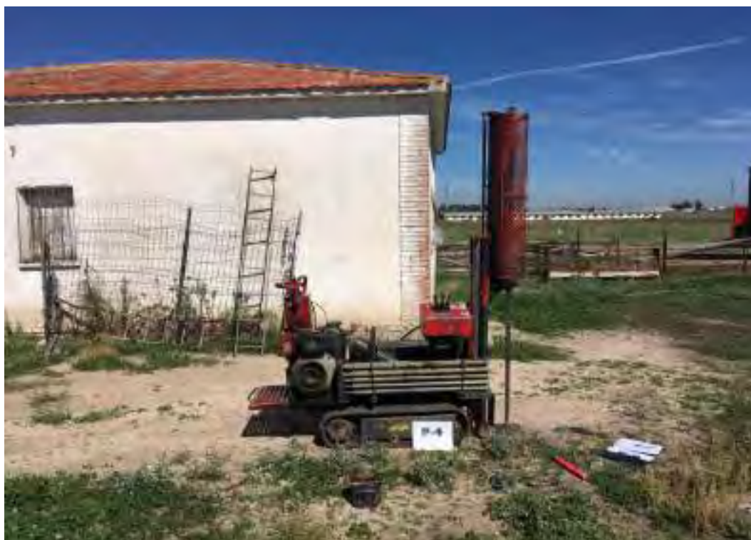
Figura Nº 27.- Trabajos para la realización de la penetración dinámica, tipo DPSH, referida como P-04.
