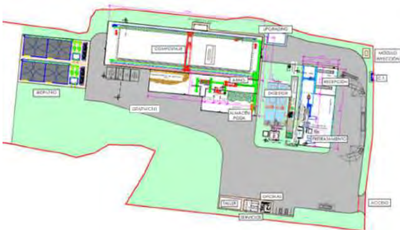
Figura Nº 2.- Distribución en planta de los diferentes elementos que conformarán la planta
