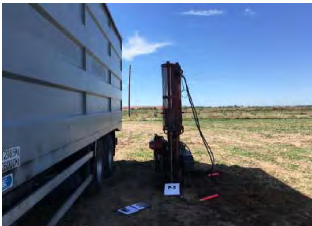
Figura Nº 26.- Trabajos para la realización de la penetración dinámica, tipo DPSH, referida como P-03.
