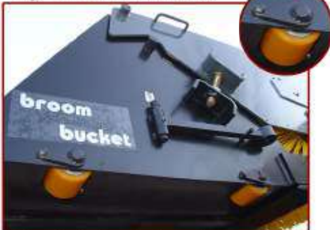
▲ Ruedas deslizamiento cuchara - opción Wheels for sliding the bucket - option
