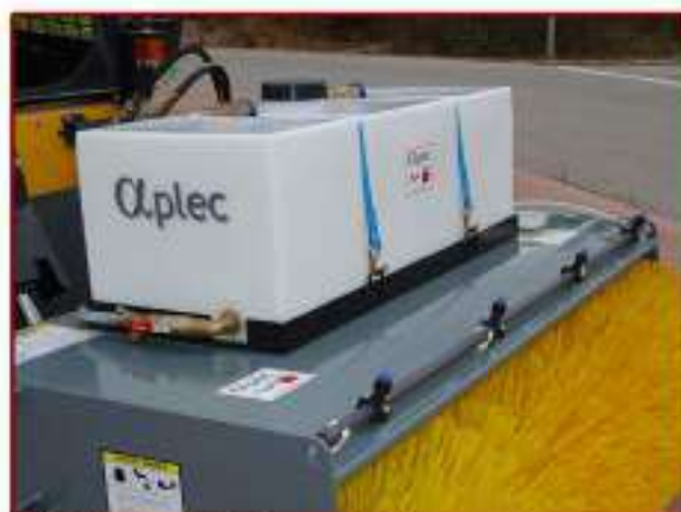
▲ Sistema de riego - opción Sprinkler system - option
