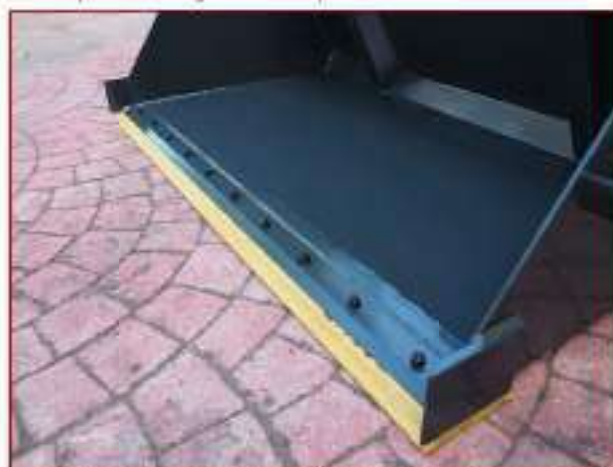
▲ Cuchilla atornillada doble uso más otra soldada Bolted blade of dual-use and other welded
