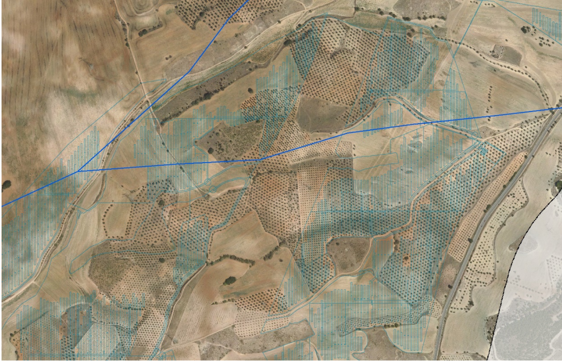
Figura 65. Delimitación Arroyo Tambara según CHT sobre ortofoto de máxima actualidad en la que no se evidencia vegetación en las áreas delimitadas como DPH.
