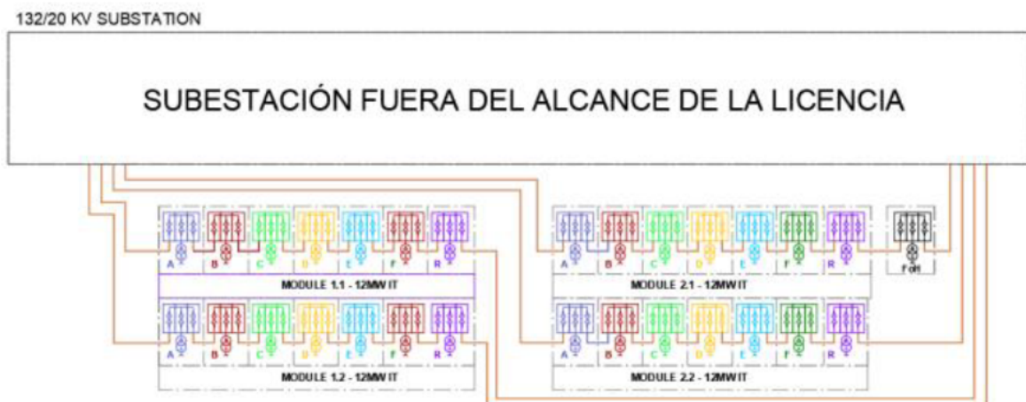
Figura 14 Red de distribución de media tensión.
