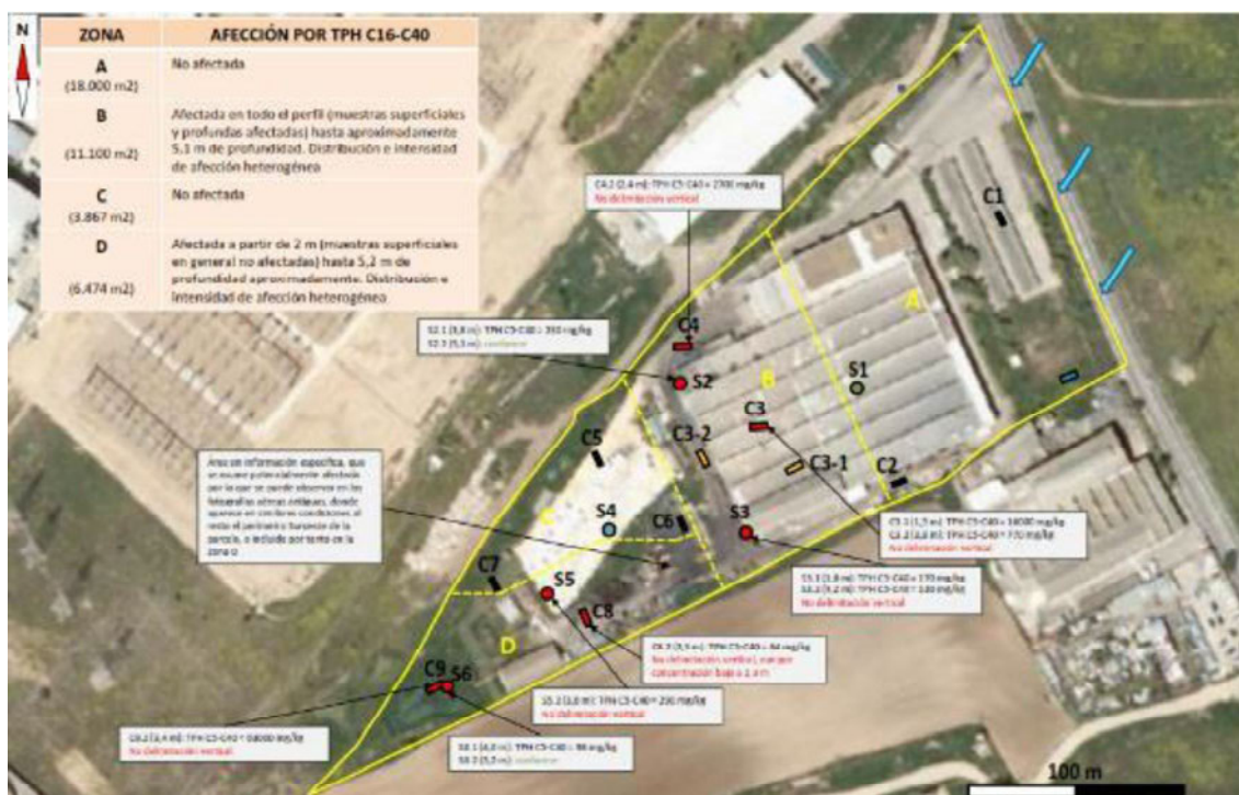
Ilustración 5. Resultados no conformes de las investigaciones ejecutadas y sectorización realizada de la parcela en base a la afección, sobre foto aérea de la antigua actividad (Fuente: ENAC-147-22)_ Planos 03 y 04.
