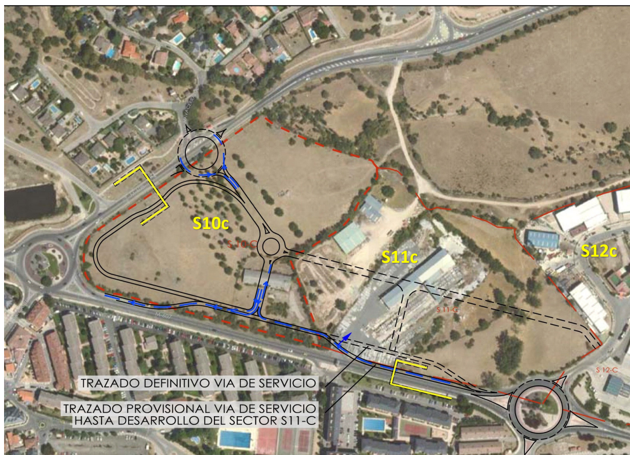
Figura 9. Esquema viario provisional y definitivo del conjunto
