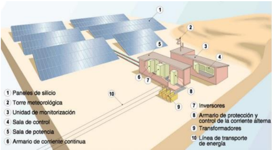
Imagen 1. Funcionamiento tipo - genérico de una Planta Fotovoltaica
