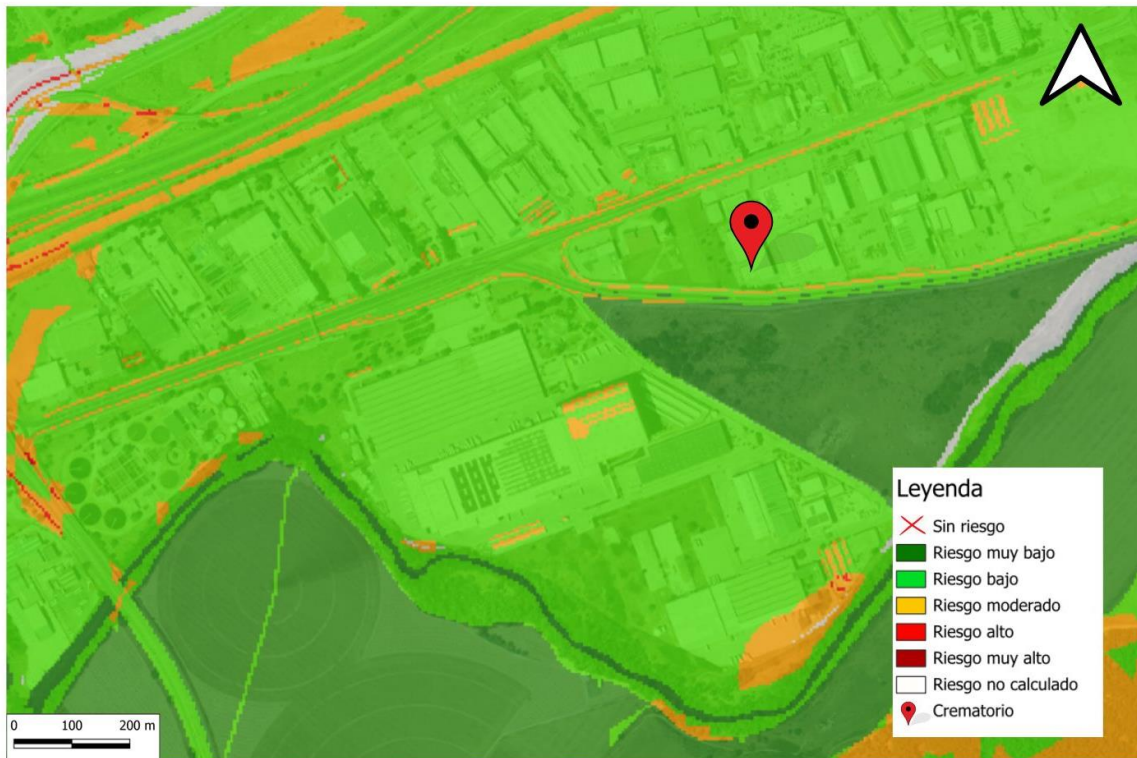
Ilustración 76. Riesgo ante movimiento de tierras. Fuente: Madrid.org
