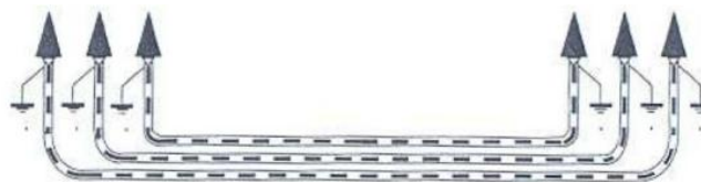
Ilustración 21. Puesta a tierra de cubiertas metálicas
