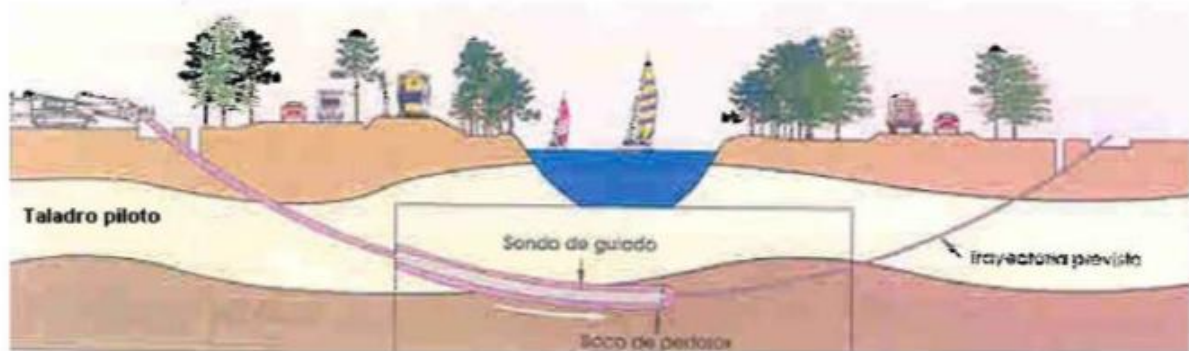
Ilustración 16. Esquema del proceso de perforación piloto
