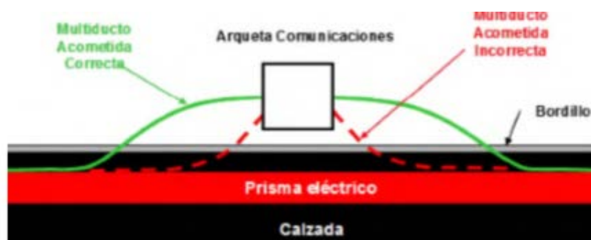
Detalla desviación y acometida a arquetas del multiducto para cableado óptico (Fuente: MT 2.33.14).
