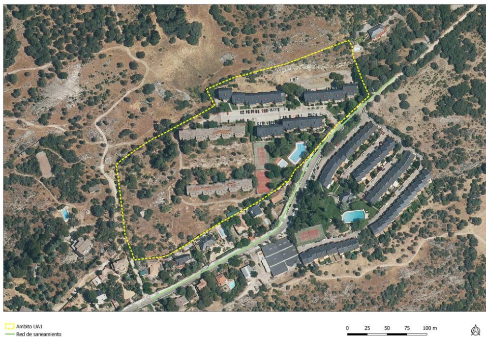
Figura 14: Red de saneamiento que da servicio al ámbito de la Modificación Puntual (Unidad de Actuación UA-1).
