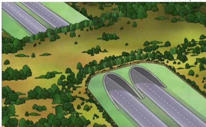
Esquema general de un ecoducto (Fuente: Miteco)
