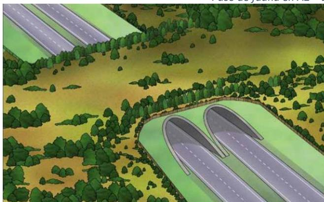
Esquema general de un ecoducto (Fuente: Miteco)
