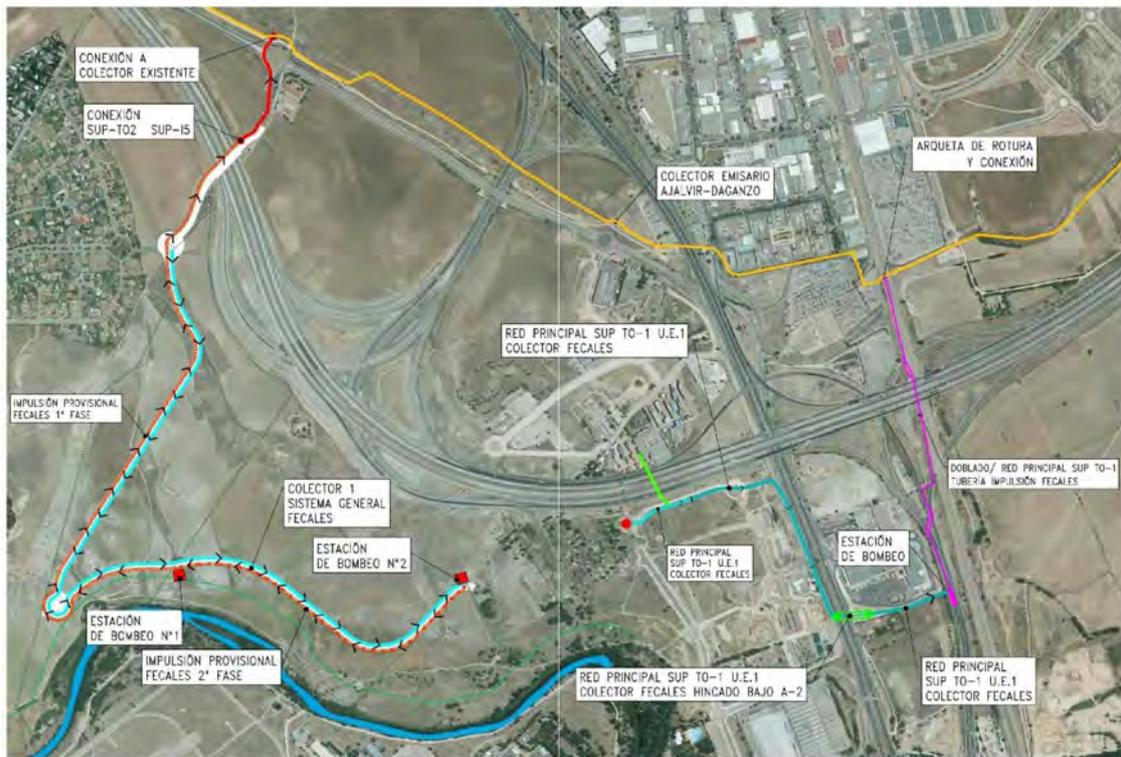
ESQUEMA DE CONEXIÓN EXTERIOR ALTERNATIVA 1 - BOMBEO
