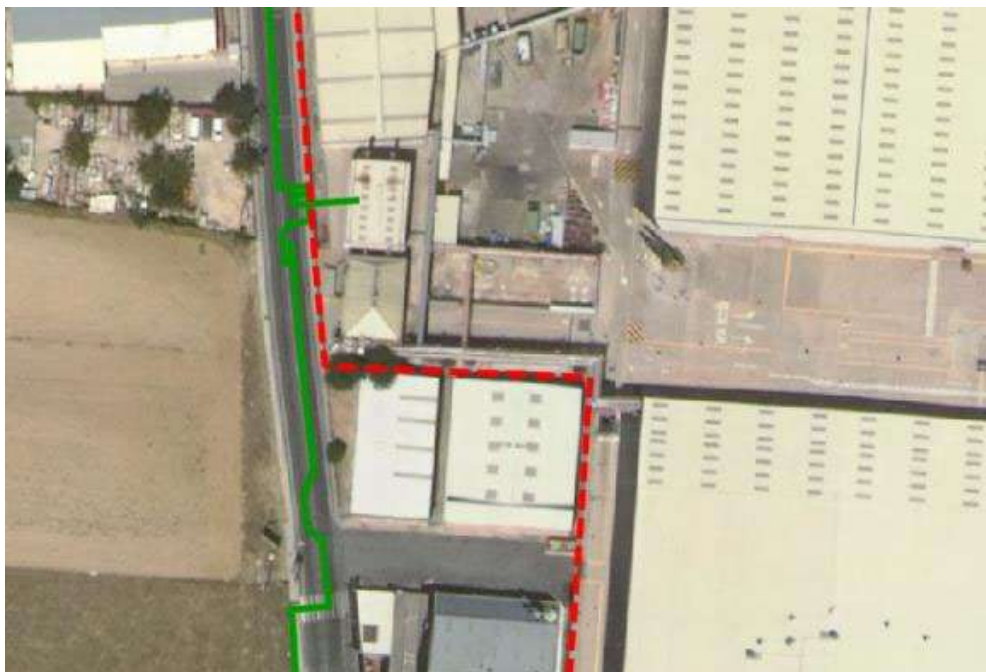
Figura 26. Conexión de gas al Oeste del Sector con tubería DN 200 mm
