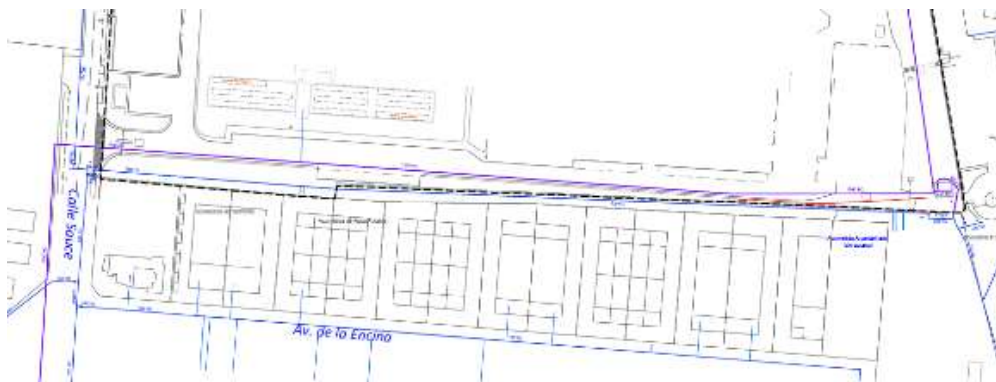
Figura 30. Tubería DN 1200 mm AC existente al Sur del APD-16
