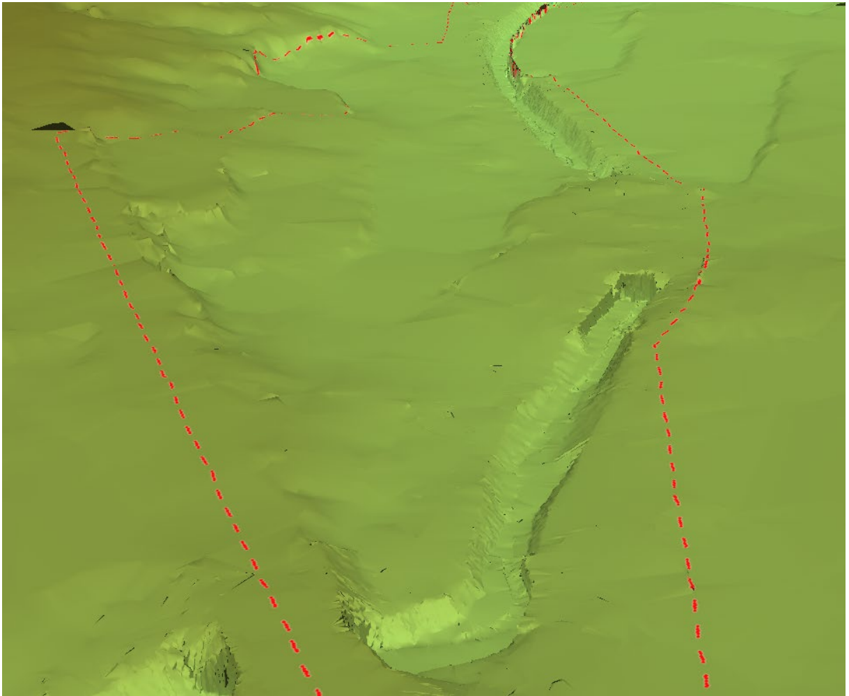
Vista 3D del MDT cauce del Arroyo Pozuelo construido desde el paso bajo la Avenida Calvo Sotelo
