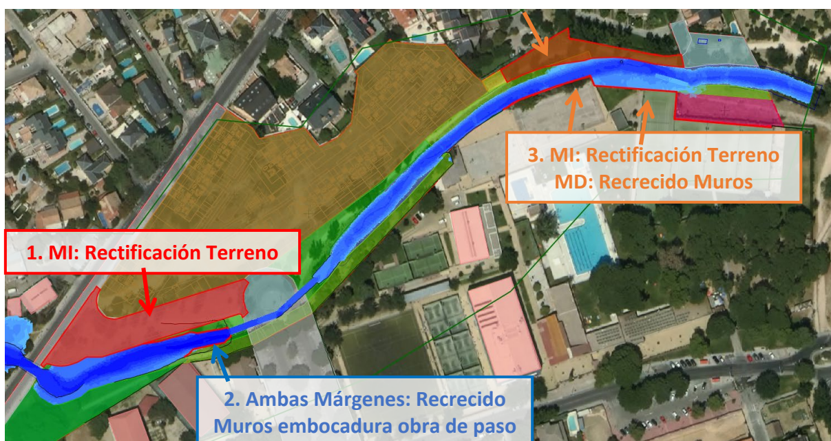
Actuaciones propuestas en Arroyo Pozuelo para evitar los desbordamientos en Q500 años
