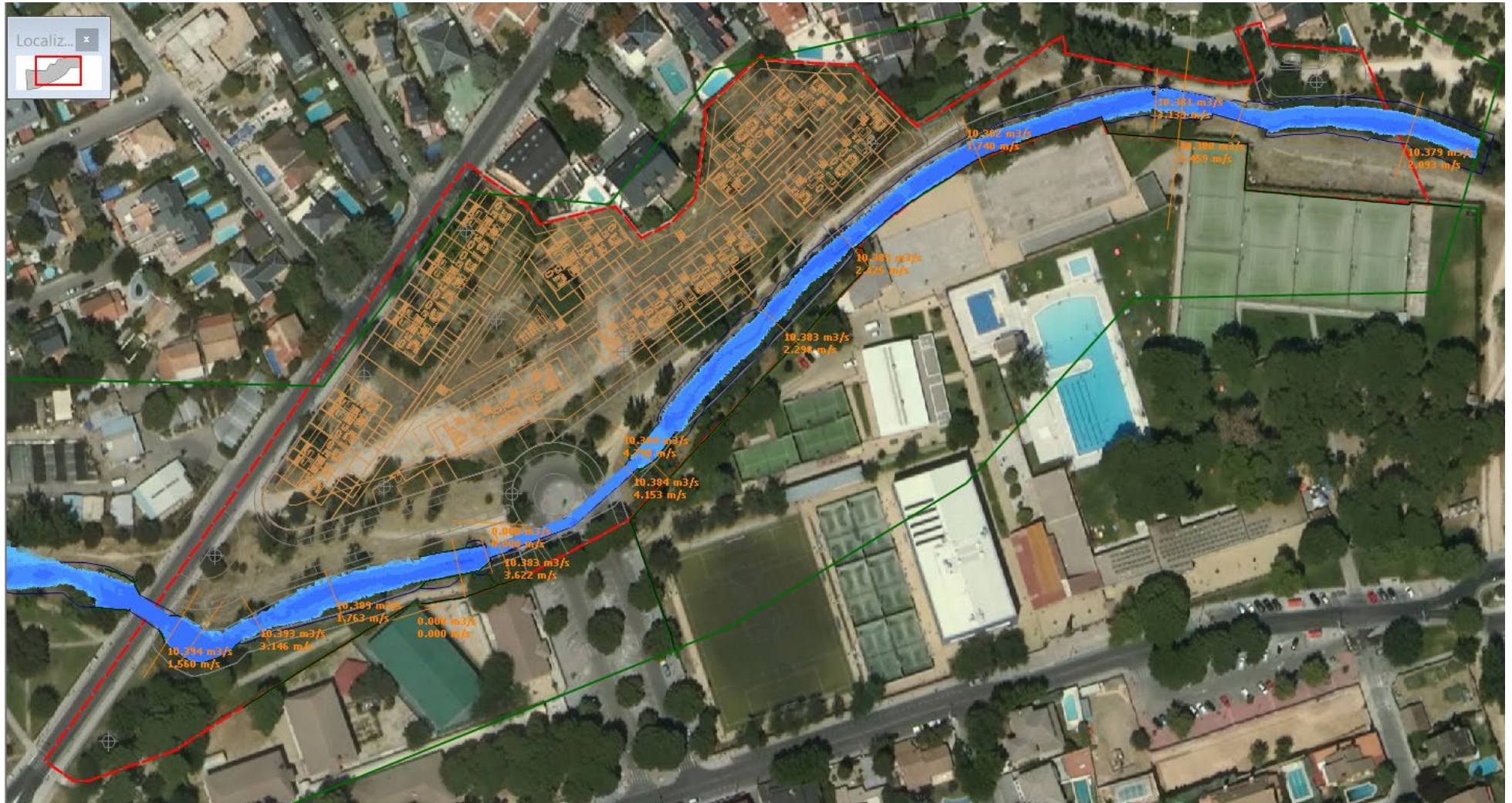
Vista general de la zona de afección de avenida para Q_5 futuro transitorio. En rojo, el límite de la parcela
