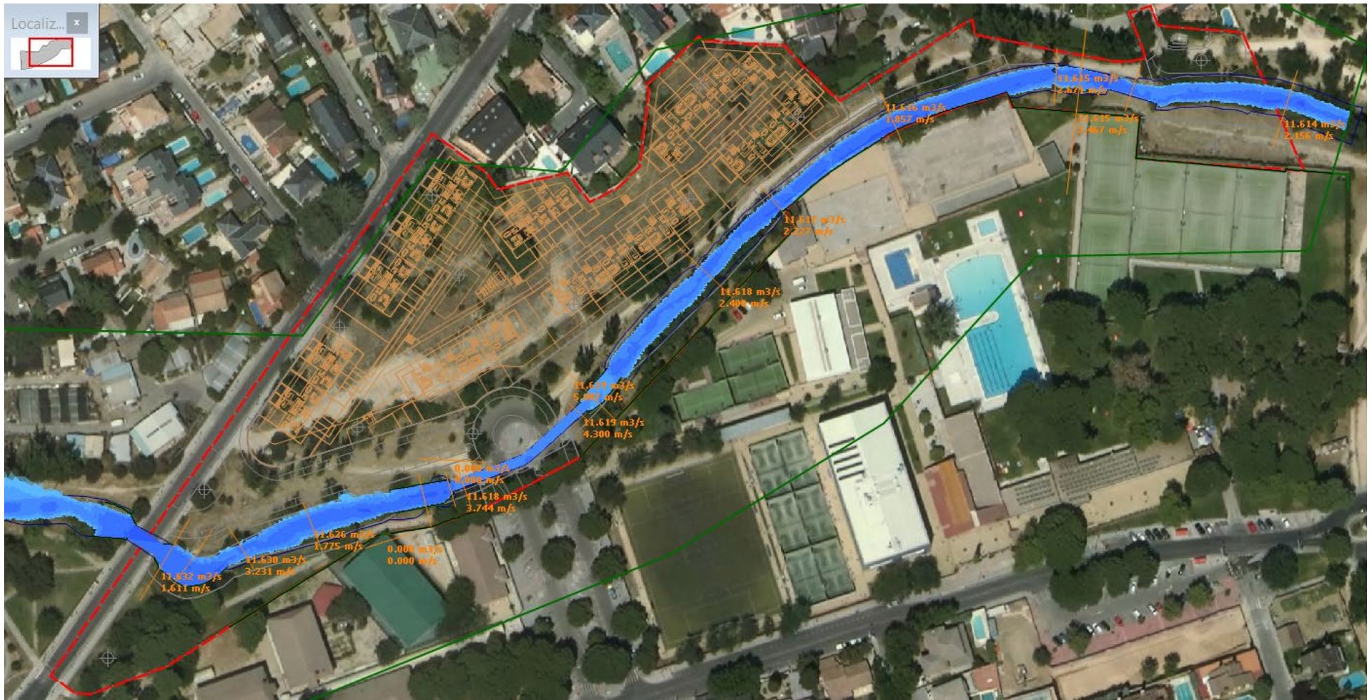
Vista general de la zona de afección de avenida para Q 10 actual. En rojo, el límite de la parcela
