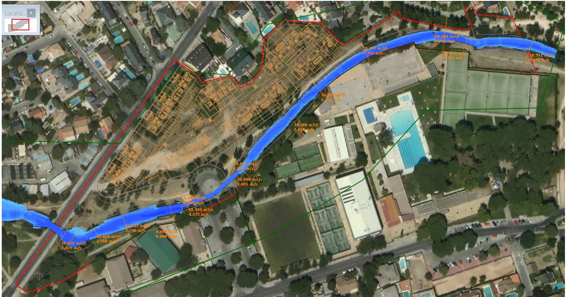
Vista general de la zona de afección de avenida para Q 25 futuro transitorio. En rojo, el límite de la parcela
