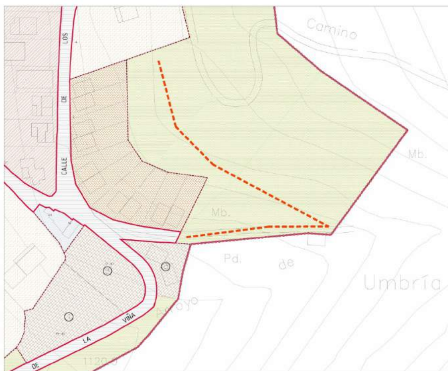
Imagen 6. Propuesta de itinerario accesible (en línea discontinua roja) que permitiría el acceso hasta las áreas calificadas como zonas verdes y espacios libres, sin conexión actualmente con las cotas de acceso peatonal.
