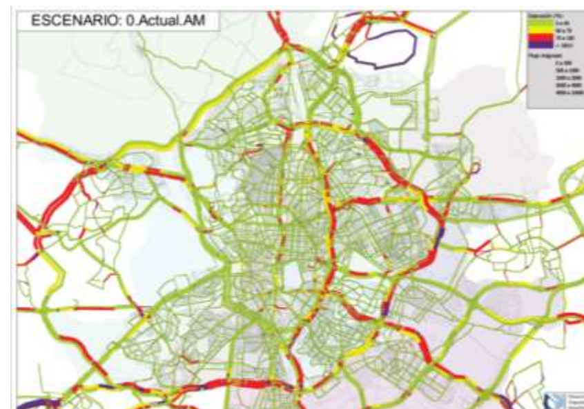
Ilustración 150. Intensidades de tráfico y nivel de saturación (Intensidad/Capacidad) en hora punta de mañana. Situación actual. Fuente: elaboración propia
