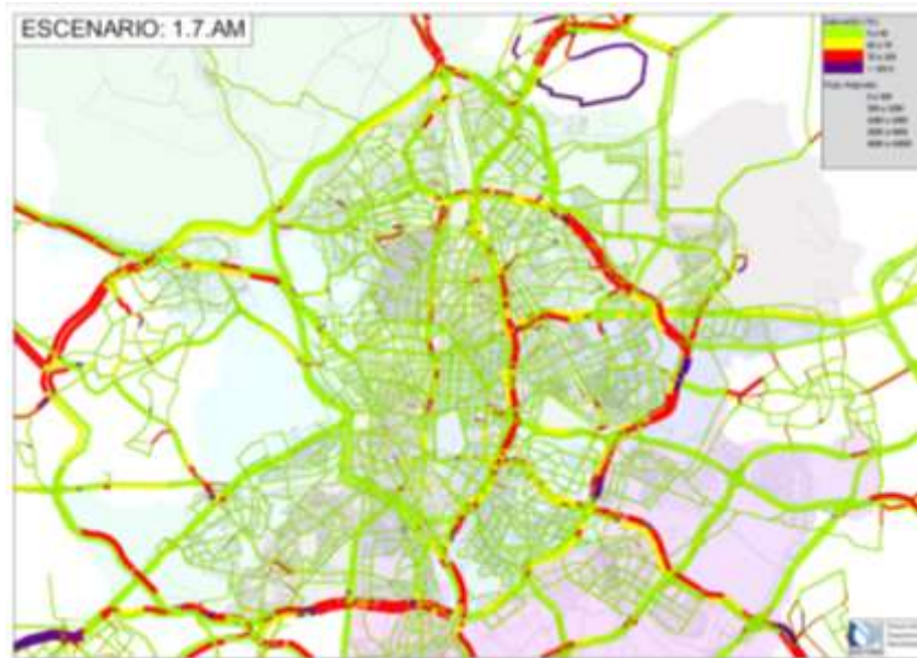
Ilustración 151. Intensidades de tráfico y nivel de saturación (Intensidad/Capacidad) en hora punta de mañana. Escenario 2023. Fuente: elaboración propia
