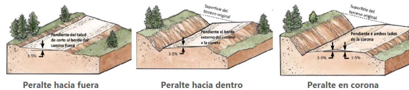
Figura 17. Esquema de situación actual y objetivo para el drenaje de caminos a través de cunetas.
