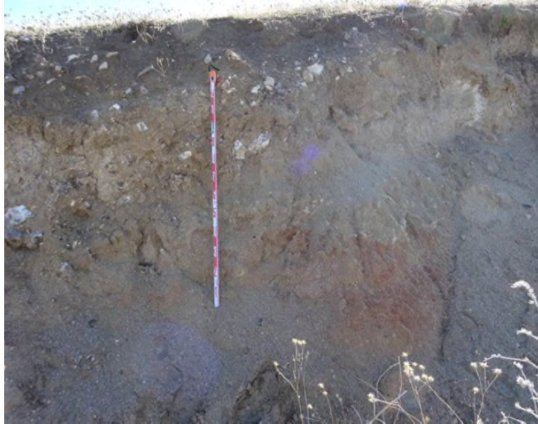
Detalle de la zona central del afloramiento A3 donde se observa el depósito coluvionar apoyado sobre arcosas arcillosas rojizas de la unidad 4 miocena.
