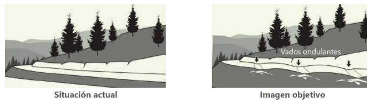
Figura 18. Esquema de situación actual y objetivo para el drenaje de caminos a través vados ondulantes.
