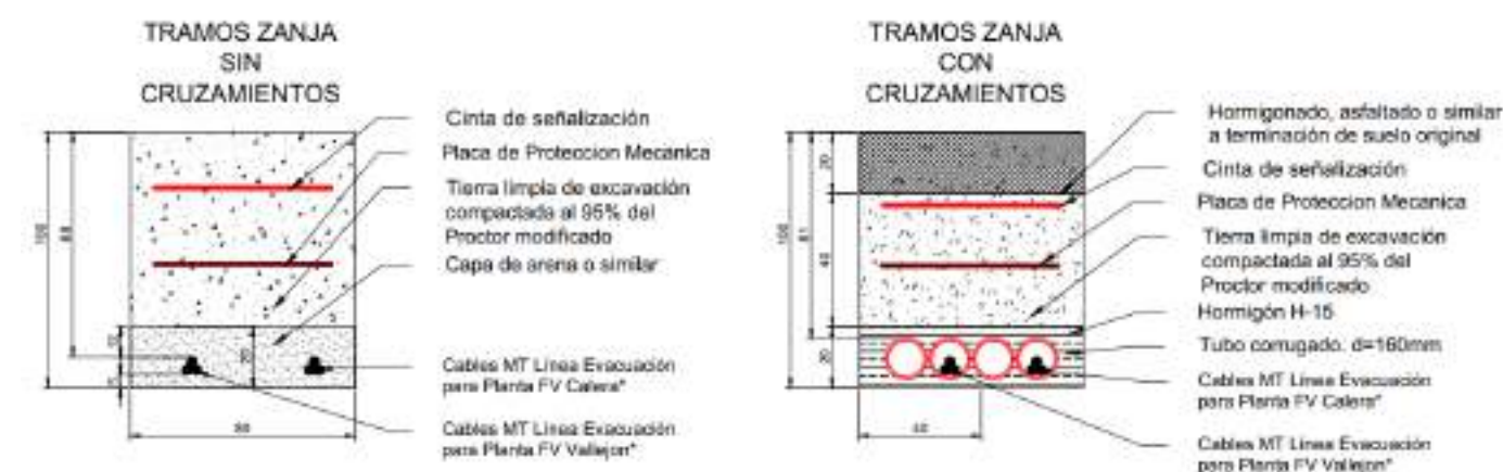
Imagen 7. Secciones tipo zanjas líneas evacuación
